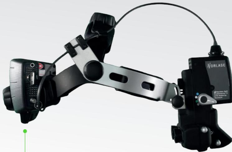
Le laser et les composants électroniques de commande sont intégrés au casque LION.
